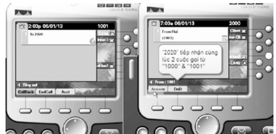
Bước 7: Máy "1001" cũng gọi đến số "2020" của máy Client cùng lúc với máy "1000"
