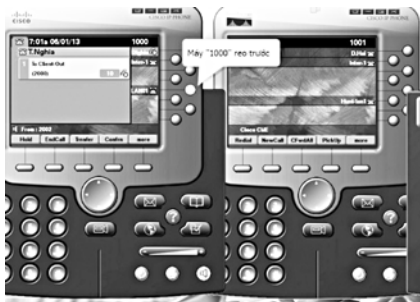
Bước 2: Điện thoại "1000" reo trước vì số freferent = 0
