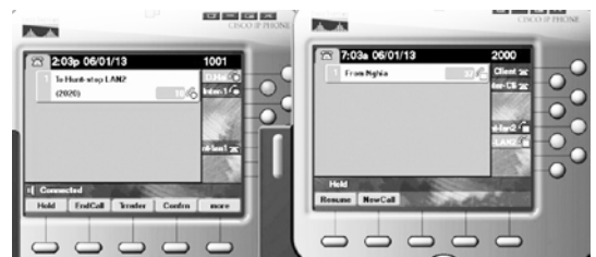
Bước 8: Máy Client thực hiện trả lời cùng lúc cho hai số máy "1000" và "1001"
