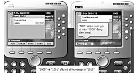
Bước 4: Cuộc gọi được chuyển sang số máy "1001" theo thứ tự ưu tiên (preferent)
