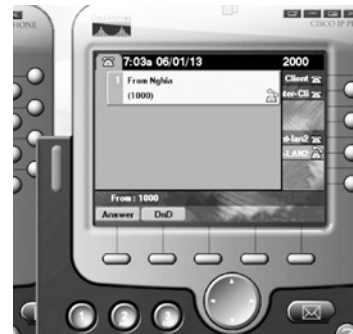
Bước 6: Máy Client nhận cuộc gọi và trả lời tại "button số 6"
